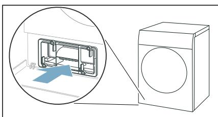
**Anvisning:** Du kan inte skjuta in värmeväxlarskyddet förrän insatsen är i maskinen.
