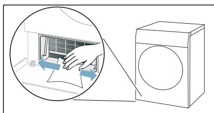
**Anvisning:** Se till så att du inte skadar den frilagda värmeväxlaren.
