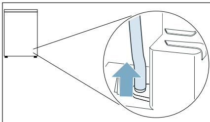
**Anvisning:** Kondensatslangen är fäst på anslutningen vid utleverans av maskinen.
