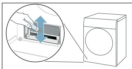
**Anvisning:** Se till så att du rengör värmeväxlarens lameller uppifrån och ned så att du inte böjer eller skadar dem.
