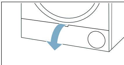
3. Lossa spaken till värmeväxlarskyddet.
