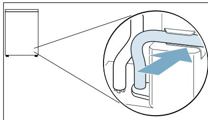
**Anvisning:** Se till så att du inte veckar avloppsslängen.
