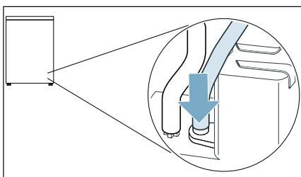
6. Tryck fast avloppsslangen i maskinens slanhållare.
