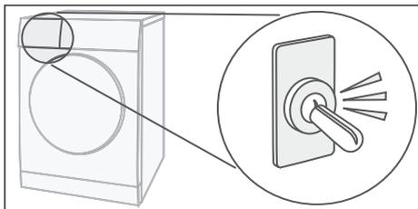
Kondensatet blir inpumpat till kondensattanken. Det ger pumpljud.
