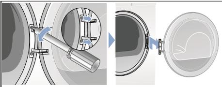
3. Lägg luckan försiktigt på plant underlag med t.ex. en handduk under, så att du inte repar eller skadar den.
