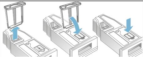
9. Skjut in kondensattanken så att den snäpper fast igen.
