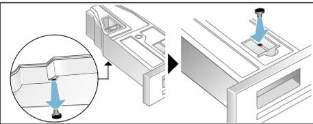
8. Dra ut filtret ur snäppfästet och sätt det i fördjupningen på kondensattanken.
